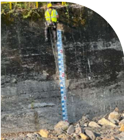
Echelle limnimétrique sur l'Arly aux Mollières, Ugine
