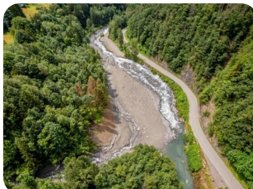
Travaux de terrassement de la rive gauche et restauration de l'espace de dépôt de matériaux en cas de crue du Nant Bruyant
