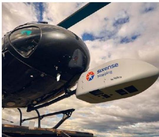
Le SMBVA a engagé un levé topographique par LIDAR sur le tronçon Arly amont et Arrondine. Il s'agit d'un levé hélicoptéré, permettant de reconstituer précisément les éléments de relief pour mettre en forme un modèle numérique de terrain.
